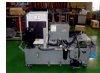
3.Tip CTS Sistemi (Su tanklı,Soğutucu Üniteli,Kağıt Filtreli ve Yağ Separatörlü)
