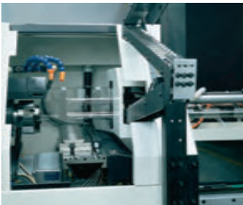
Parça yükleme sistemi + parça yakalayıcı (opsiyon)
