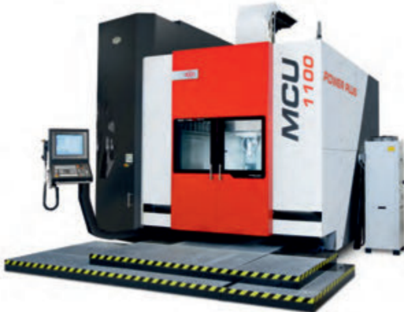
5 Eksen Dik İşleme Merkezi Maksimum İşleme Çapı: 1250mm X:1100mm Y:1550mm Z:1000mm
